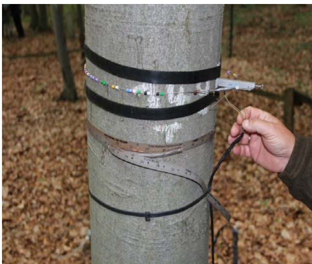
Bild 1: mechanisches Umfangmessband und automatisches Dendrometer (HMS Possen)
